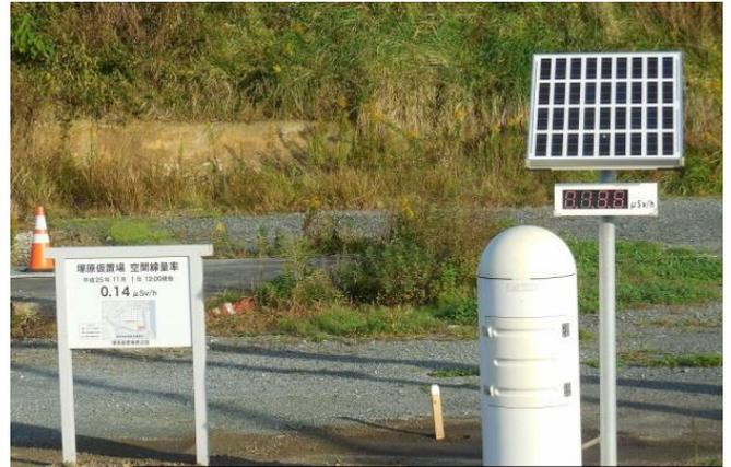
国(原子力規制庁)設置の空間線量計下に鉛が敷かれ、値が低く出ている。
